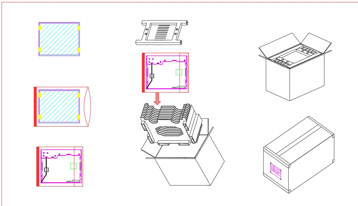
Max capacity : 8 TFT-LCD module per carton
